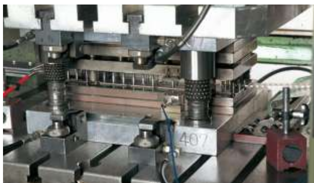
* 精密金属部品のプレス工程。盛岡セイコー工業様の許諾の下、Web サイトより転載
